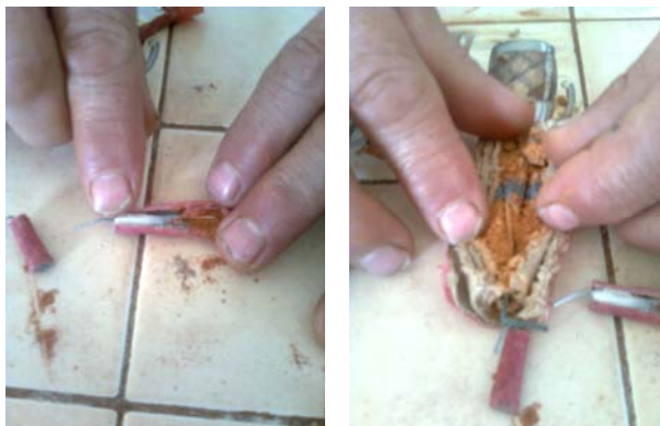
Pétard de type K1 : plâtre, poudre, bourre / bourre, poudre, bourre : la trop faible quantité de poudre rend son extraction quasiment impossible.
